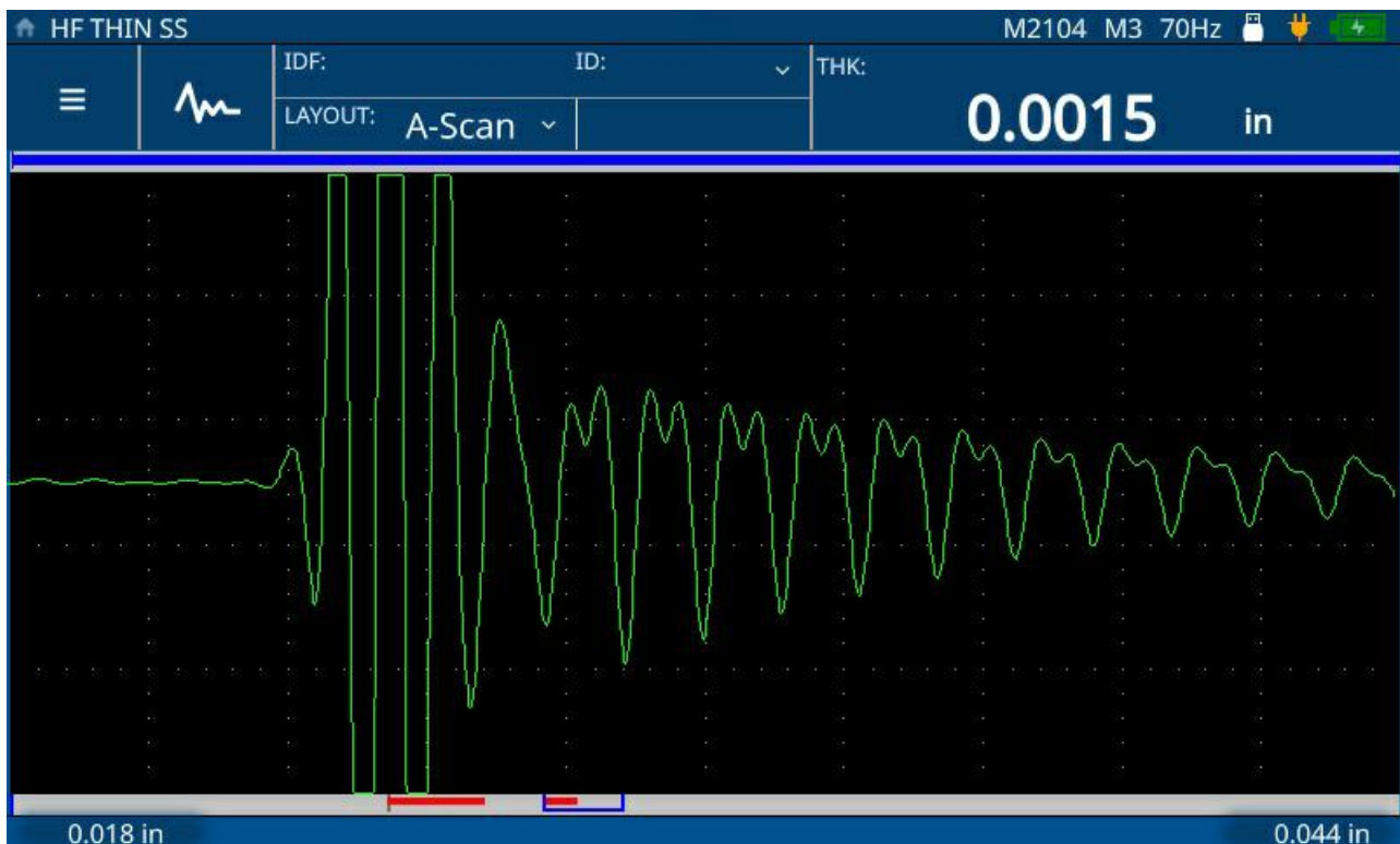
Le 72DL PLUS mesure une pièce d'acier de faible épaisseur (0,0381 mm [0,0015 po]) à l'aide de la sonde M2104 (125 MHz).
